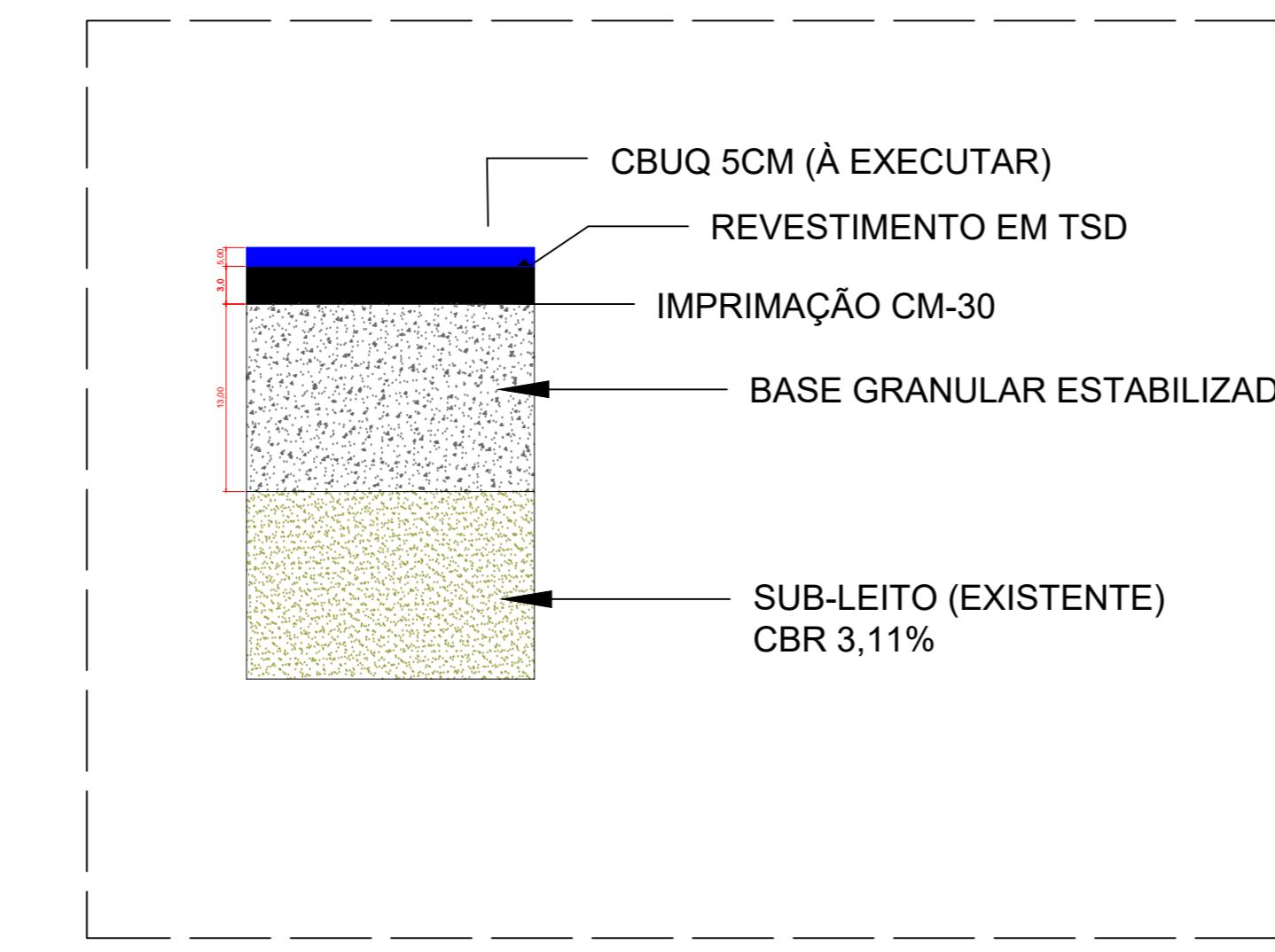
07 A0 1/200 ESTRUTURA DO PAVIMENTO DO PÁTIO DE AERONAVES
